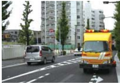
▲路面下空洞探査車
